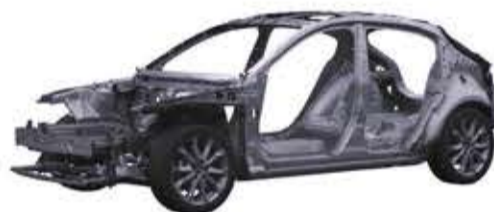
マツダの新世代プラットフォーム「SKYACTIV-Vehicle Architecture」。
