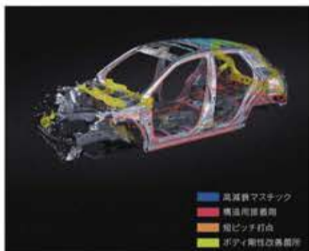
レクサスのコンパクトSUV・LBX MORIZO RRの高剛性ボディ。ノーマルLBXと比べ、構造用接着剤を12.8m延長。
