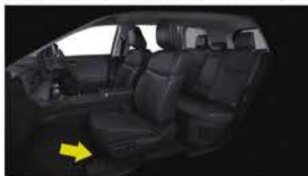
ADASドメインコントローラコンピュータASSYは助手席下部に搭載(矢印) 画像提供: トヨタ自動車(一部加工)
