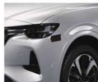
マツダ・CX-60のフロントバンパー修理禁止エリア（イメージ）。修理禁止エリアの再塗装は不可。 画像提供: マツダ株式会社
