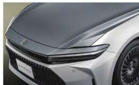
新型クラウンにはフロントバンパーに6つのソナー系センサーが埋め込まれている 出典: トヨタ自動車株式会社
