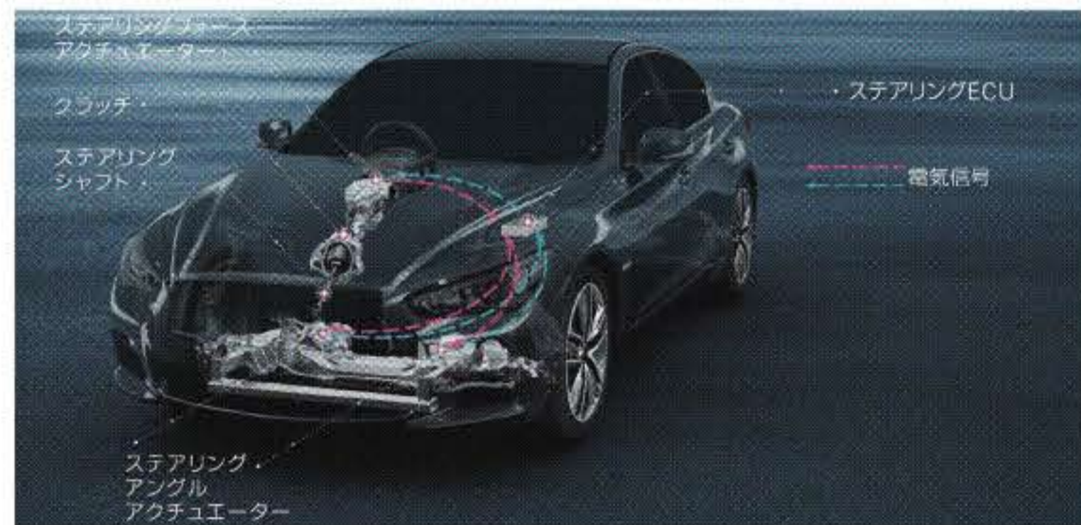
ステアバイワイヤ技術など、あらゆる制御が電子化されており、それに伴い ECU の数も増加しています。出典：日産自動車株式会社
