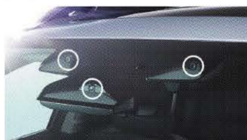
ステレオカメラ(両端の円)と単眼カメラ(中央の円)を用いた新アイサイト。 出典：株式会社SUBARU
