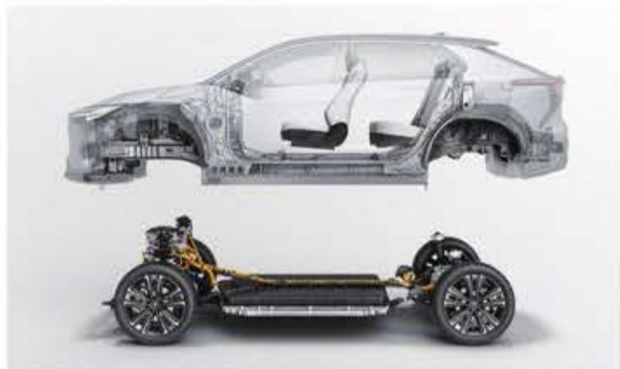
トヨタのEV、bZ4Xのプラットフォームとボディ。プラットフォームはスバルと共同開発したEV専用の「e-TNGA」を採用。(出典:トヨタ自動車)
