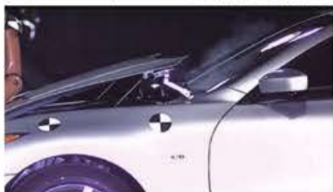
展開したポップアップエンジンフード 出典: 日産自動車
