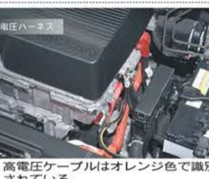
高電圧ケーブルはオレンジ色で識別されている
