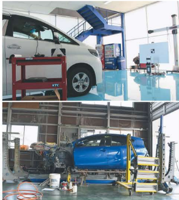
次世代自動車時代の車体整備にはコンピューターを用いた作業が欠かせない(上)エーミング作業風景(下)フレーム修正作業風景
